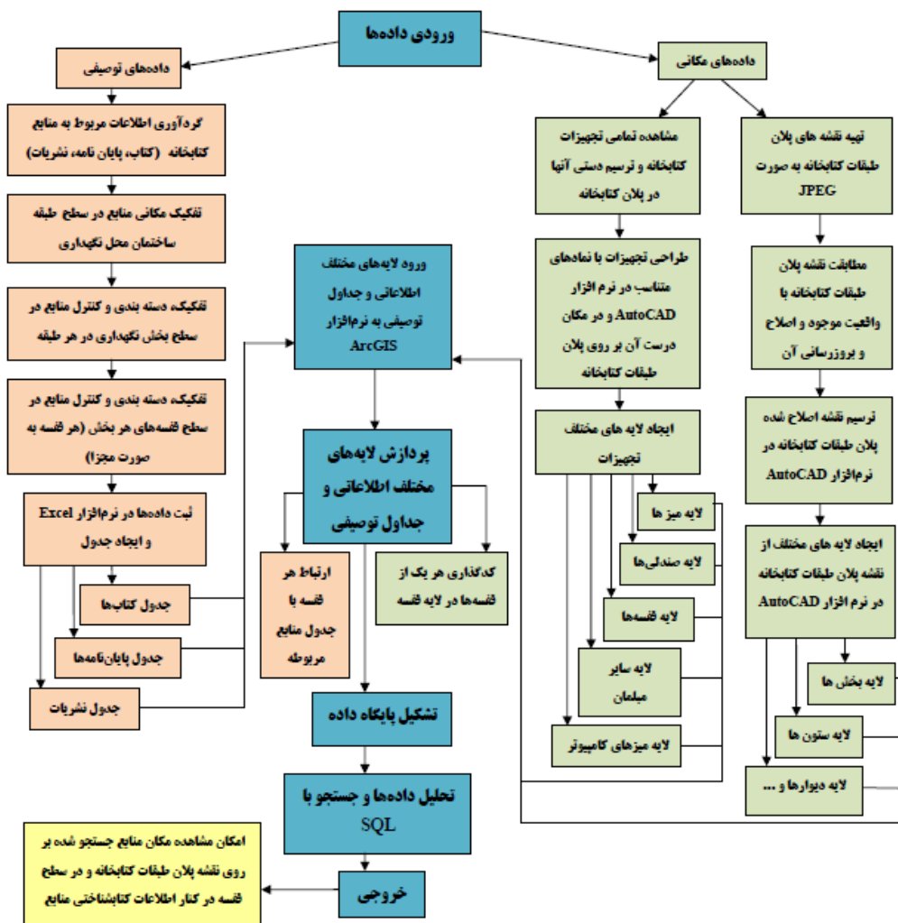
شکل ۵. مدل پیشنهادی بازنمایی مکانی مجموعه منابع کتابخانه با استفاده از جی‌آی‌اس
